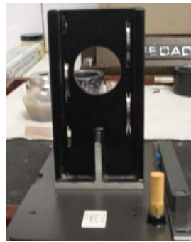
Figure II.14 : (a) Schéma de principe de la spectrométrie FTIR en transmission et (b) le montage de transmission en incidence normale.
