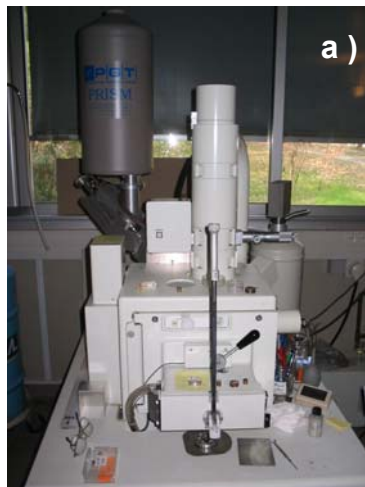
Figure II.21 : (a) microscope électronique à balayage équipé du système de dispersion d'énergie des électrons , (b) Spectre EDS d'un film d'AlN.
