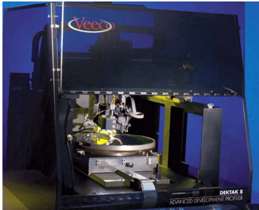
Figure II.10 : (a) Profilomètre DEKTAK 8 de la société VEECO (b) et profil obtenu sur un échantillon après dépôt d'une couche en compression avec Principe de la mesure de contrainte par Profilomètre.
