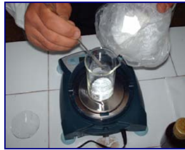
Figure III-2 : La pesée des oxydes
