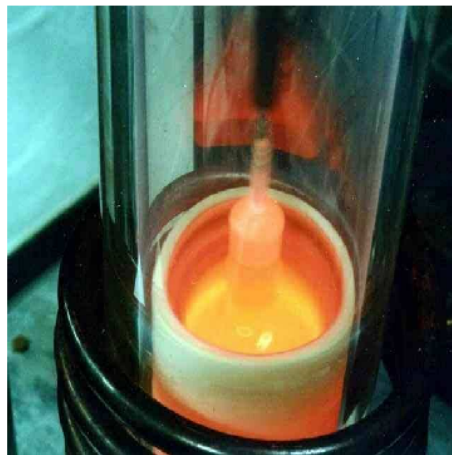
Figure III.2 : Principe de la méthode de tirage de Czochralski.
