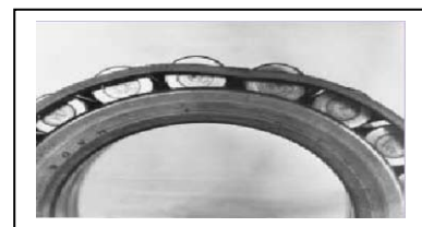
Fig- (III-18) : Déformation de la cage. [33]
