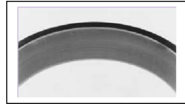
Fig- (III-19): Usure par coloration de la bague externe. [33]
