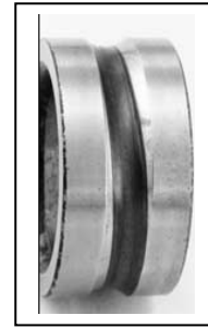
Fig- (III-8): Ecaillage unilatéral de la bague interne. [32]
