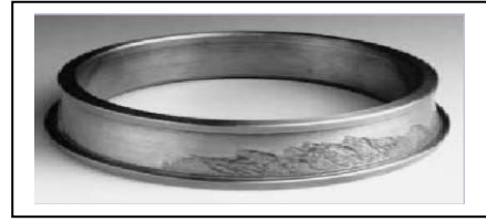
Fig- (III-11):_Ecaillage de fatigue de la bague interne d'un roulement conique. [33]
