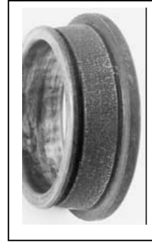
Fig- (III-15) : Corrosion d'une bague interne. (cone d'un roulement conique). [33]
