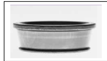
Fig- (III-17): Usure par abrasion d'une bague interne. [33]
