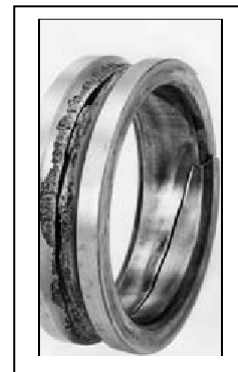
Fig- (III-5) : Ecaillage par fatigue d'une bague interne. [32]
