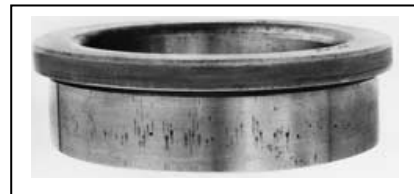
Fig-(III-6): Rayures de la bague interne. [32]
