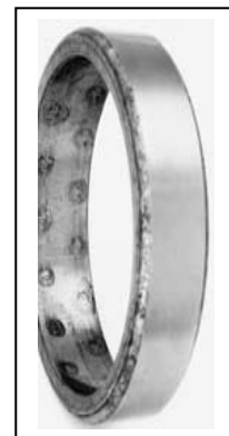
Fig- (III-10) : Ecaillage unilatéral de la bague externe. [32]
