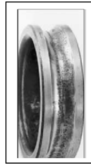
Fig- (III-4): Ecaillage de la bague interne.[32]
