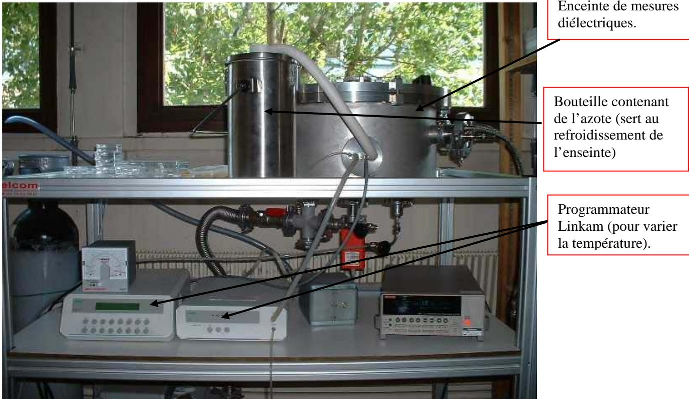
Figure III.13. Photographie de l'enceinte de mesures diélectriques.
