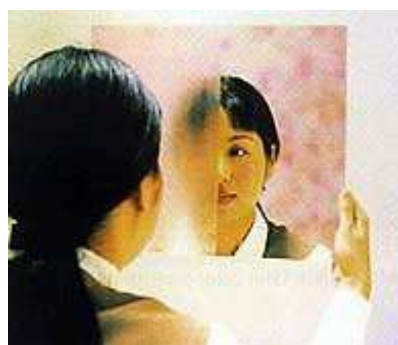
(b) Un exemple de traitement anti-buée [16]
