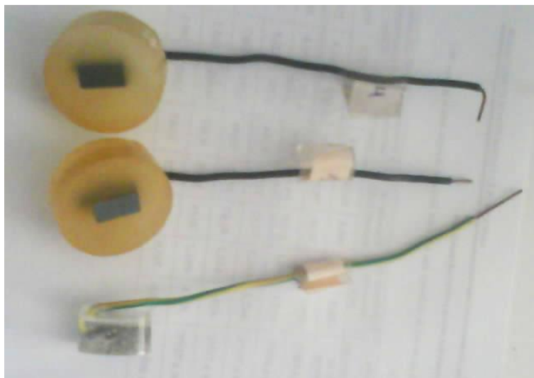
Fig. 23 photographie des échantillons enrobés pour analyse électrochimique.
