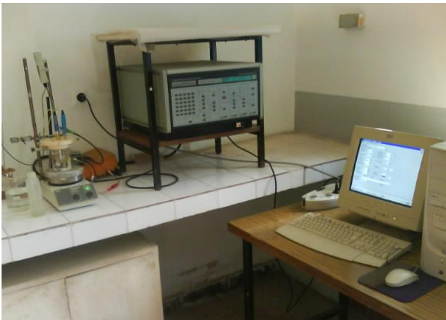
Figure.25 Appareillage utilisé pour les essais électrochimique (Potentiostat).
