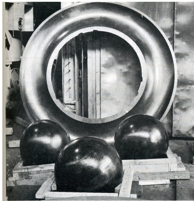
Figure 1.3. : Boulets et anneaux pour pulvérisateurs à charbon en fonte blanche martensitique [1]
