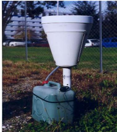
**Photo (7) :** exemple de Pluviographe à augets, avec bidon de récupération de l'eau captée par l'impluvium (photo J.-L. Bertrand-Krajewski).
