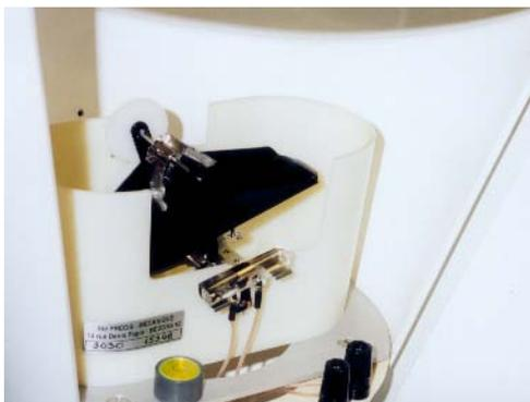
**Photo (6)** : détail du mécanisme des augets (photo LCPC Nantes)
