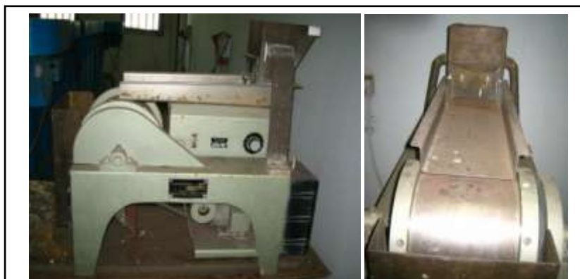
Figure 34 : Séparateur magnétique à aimant permanent (type laboratoire)
