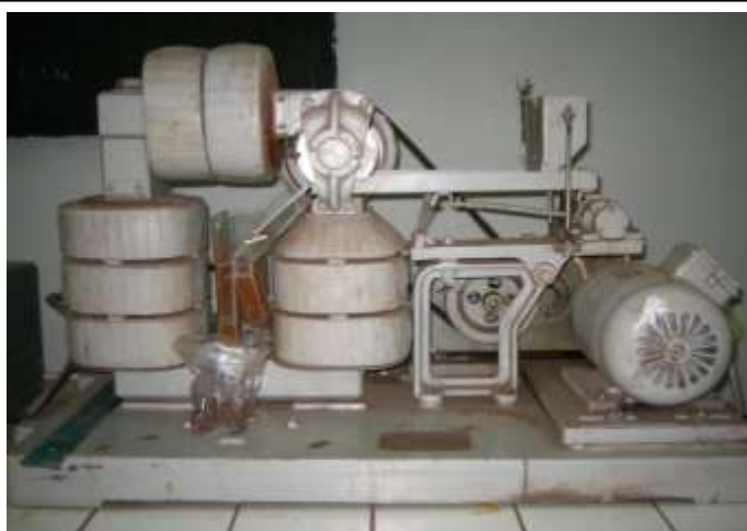
Figure 33 : Séparateur à électroaimant de type laboratoire à champ magnétique à haute intensité
