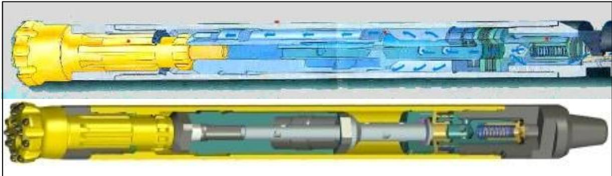
Figure 3.13 : Coupe d'un marteau fond de trou (DTH). <sup>[51]</sup>
