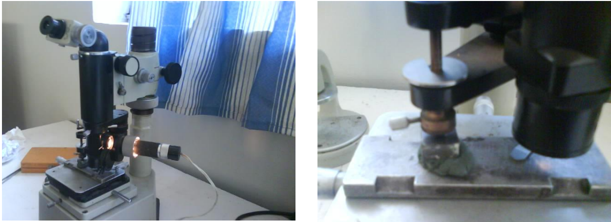
Figure IV.10 : Microduromètre (laboratoire métallurgie Annaba)
