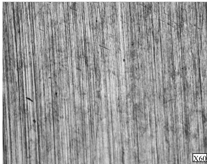
Figure V.15. Micrographie optique des striées d'usure d'un acier cimenté (Cem6h) après 400m de parcours
