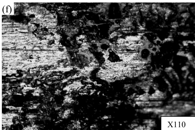
Figure III.10 (Planche 1 et 2) Micrographies optique des parties usées (a,b,c,d,e,f)
