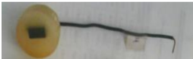
Figure IV.13. Schéma d'un échantillon enrobé (électrode)
