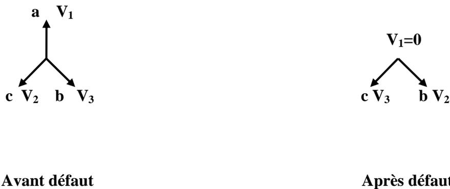
**Figure 1.11 : Défaut monophasé dans un système avec neutre à la terre.**
