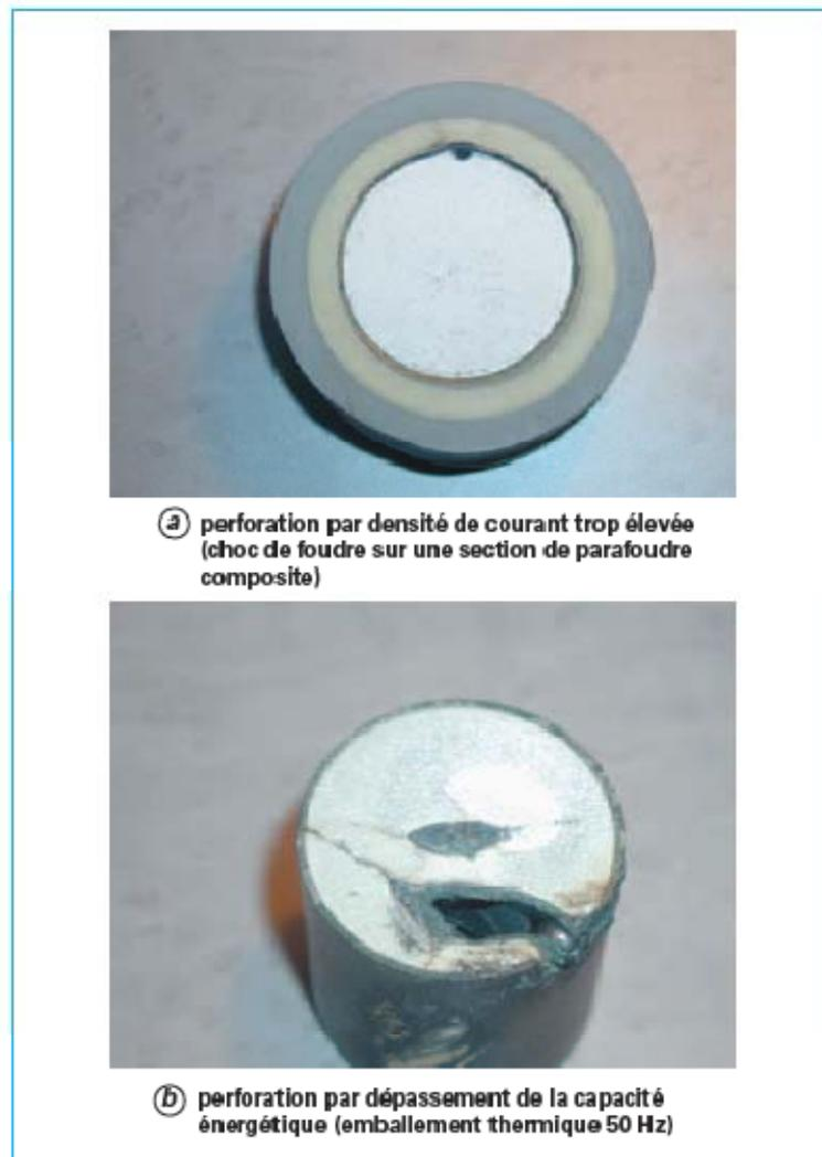
**Figure 3.11 : Perforation des varistances par dépassement de la capacité énergétique [5].**
