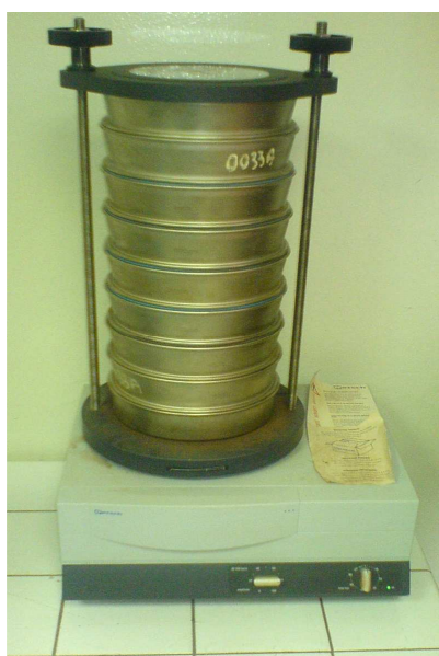
Figure IV.2.4.b Tamiseuse de laboratoire type Retsch AS200 Basic
