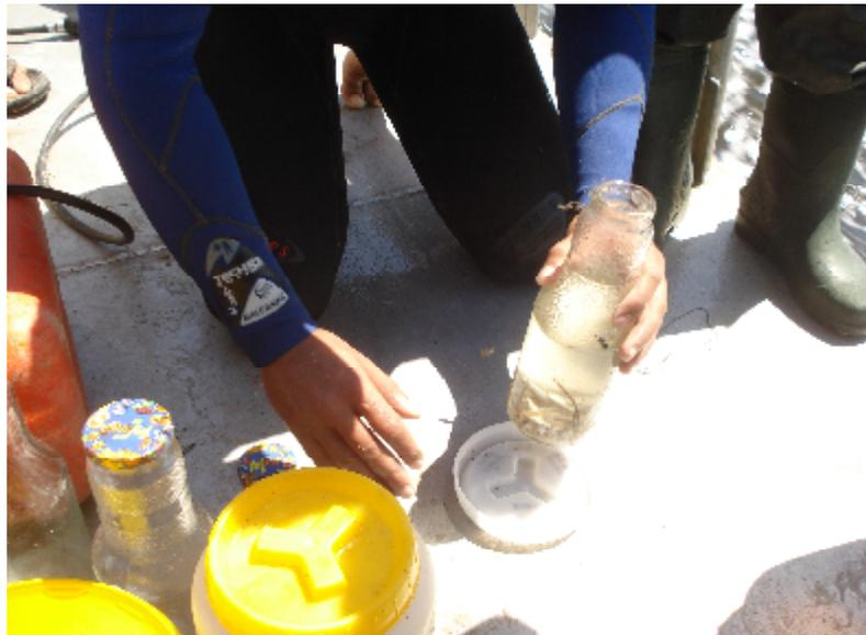
Figure 12. Bocalisation et alcoolisation des échantillons
