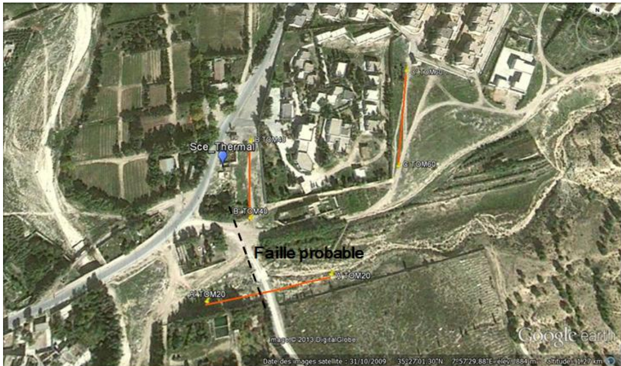
Fig. 64. Localisation des profils de tomographie électriques. (Coté de la source thermique de Youkous)
