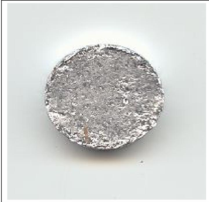
Figure II-3. Photo de la pastille du mélange des 2 poudres Al et Ti.
