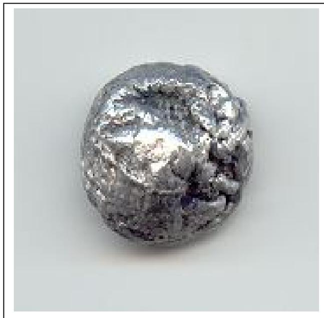
Figure II-7. Photo de l'alliage Al-Ti à l'état brut après élaboration.
