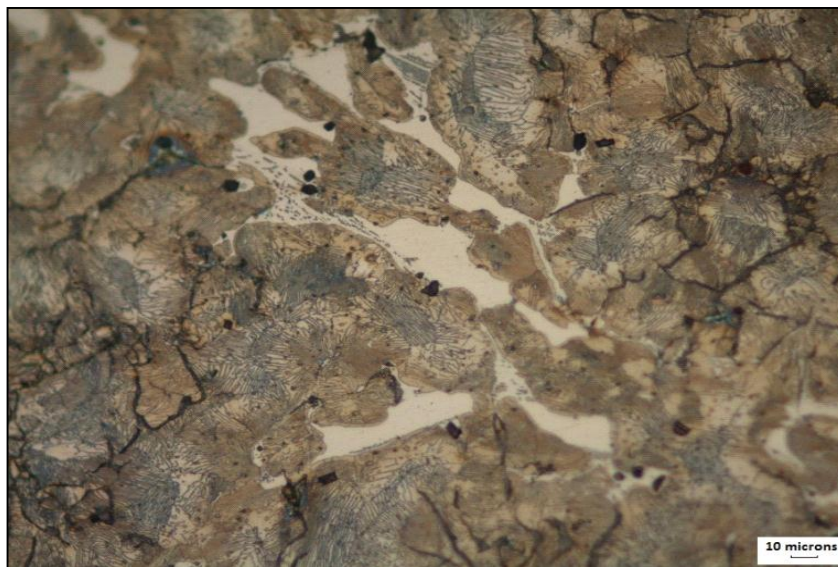
Figure 36. Structure de l'alliage à l'état neuf sous fort grossissement.
