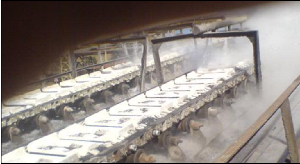
Figure 25. Augets montés sur chaine mécanique chaulés et prêts à recevoir le métal liquide.
