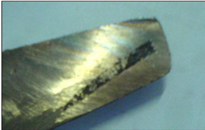
Figure 28. Cavité interne observée dans l'épaisseur de l'auget.
