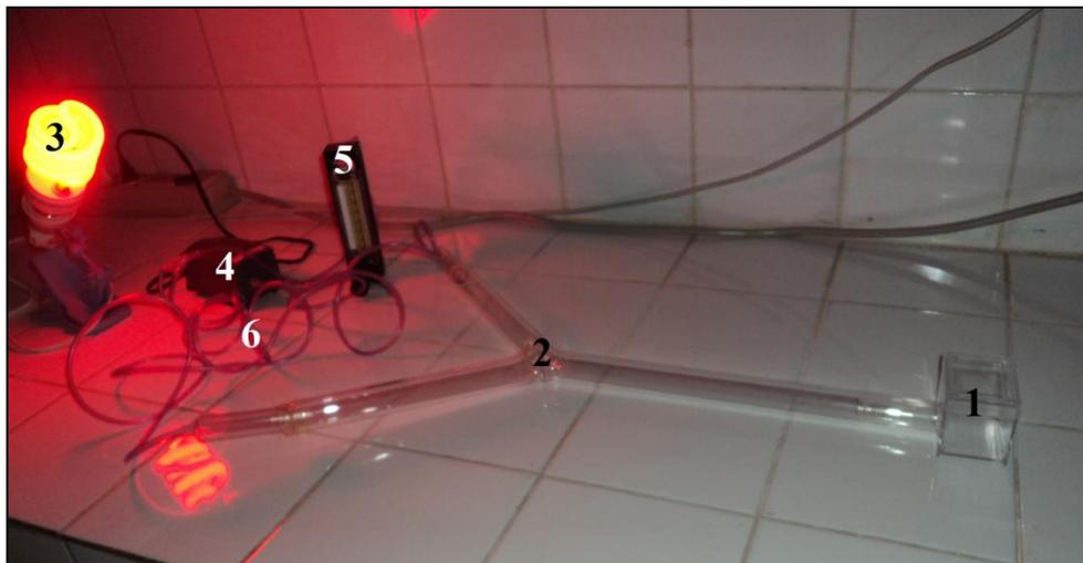
**Figure 40.** Olfactomètre Bidirectionnel en Y. 1, Boîte de départ; 2, Olfactomètre; 3, Lampe rouge; 4, Compresseur; 5, débitmètre; 6, tuyaux d'arrivée d'air
