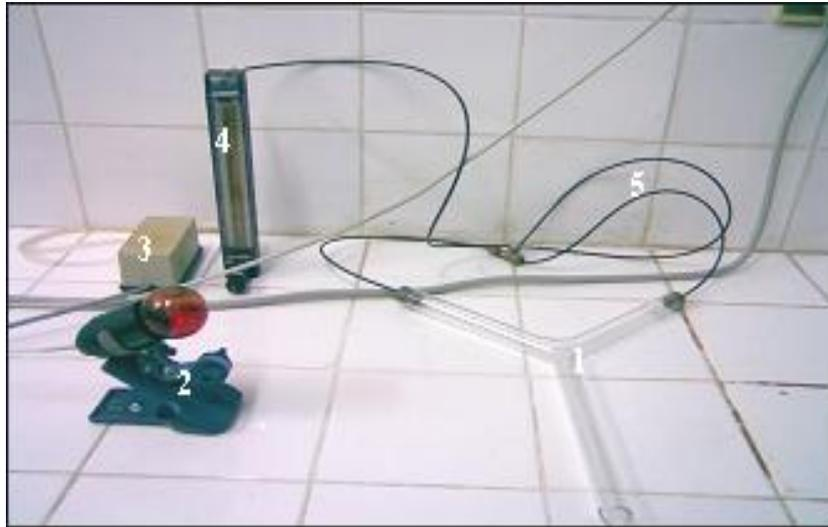
**Figure 15.** Test en olfactomètre (1, tube en Y; 2, lampe rouge; 3, compresseur; 4, débitmètre; 5, tuyau en téflon)
