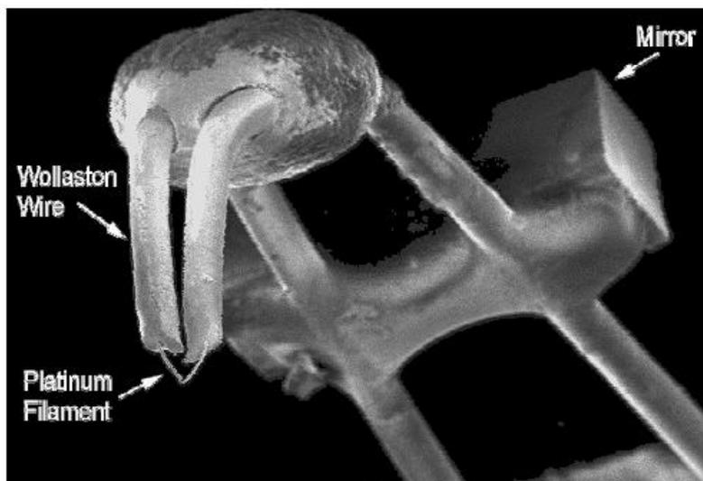
**Figure V.2 :** Image de la sonde montrant le filament, le fil Wollaston et le miroir [1]
