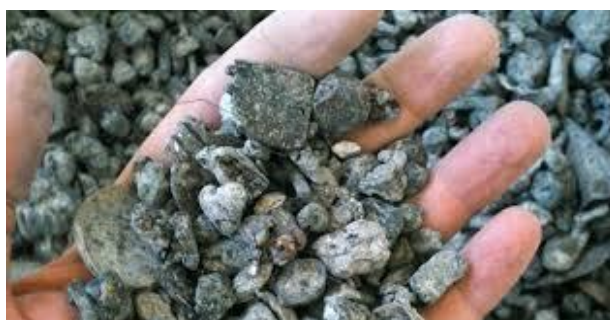
Figure 2.10 : Les granulats ferreux (Vimane, 2006)
