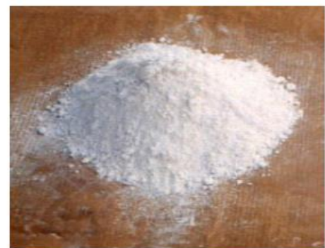
(b) Poudre de chaux éteinte
