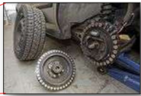
Figure I.12. Moteur « in Wheel » pour véhicules
