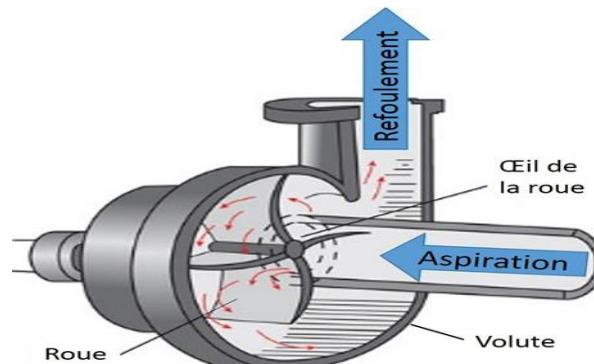
**Fig. II.16 :** Centrifugal Pump
