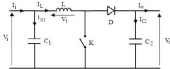
**Fig. III.7:** Boost Converter
