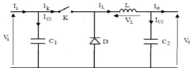
**Fig. III.4:** Buck Converter
