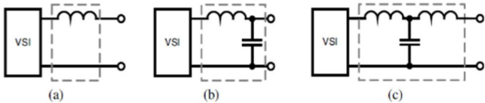
**Fig. III.12:** Basic Filter Topologies
