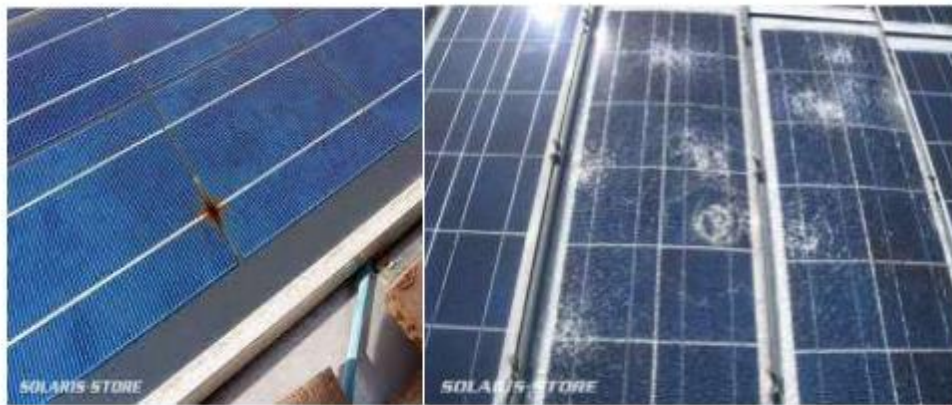
Fig II.3 : Fissuration et dommages cellulaires
