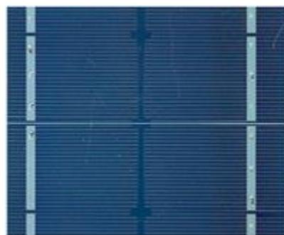
**Figure I-11 :** Cellule solaire à base de Silicium monocristallin.
