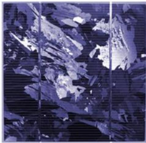
**Figure I-12 :** Cellule solaire à base de Silicium polycristallin.
