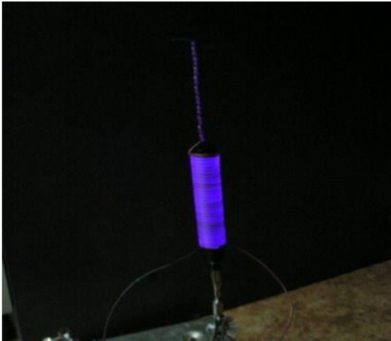
Figure II.13 Effet de couronne avec présence de petites saillies à la surface des conducteurs
