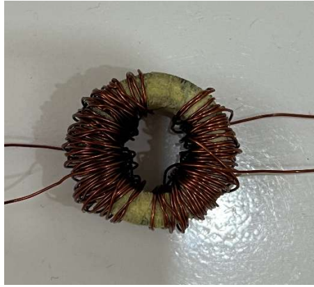
Figure 3.1 : Ferrite MnZn après bobinage par le fil de cuivre
