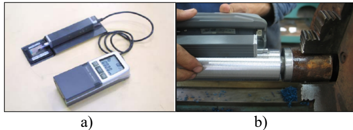
Figure II.5: Mesure de topographie in situ avec le rugosimètre portable Mitutoyo.
