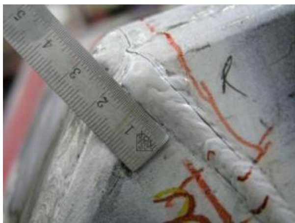
Figure VI. 18: Exemples de fissures sur aluminium
