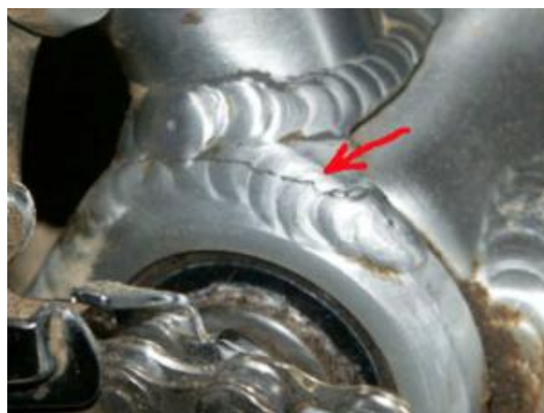
Figure VI. 18: Exemples de fissures sur aluminium
