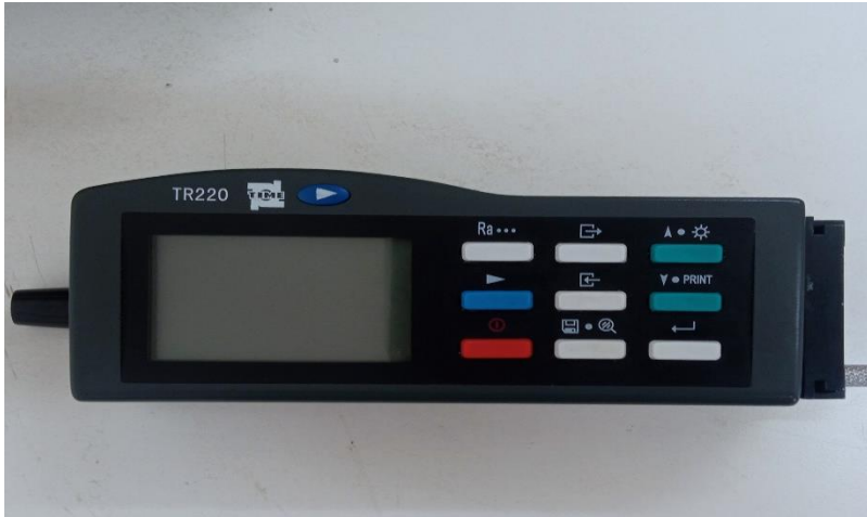
Figure III.5: rugosimètre TR220 (2D).
