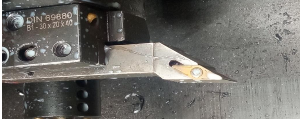
Figure III.3: plaque montée sur porte outil de chariotage finition utilisé.
