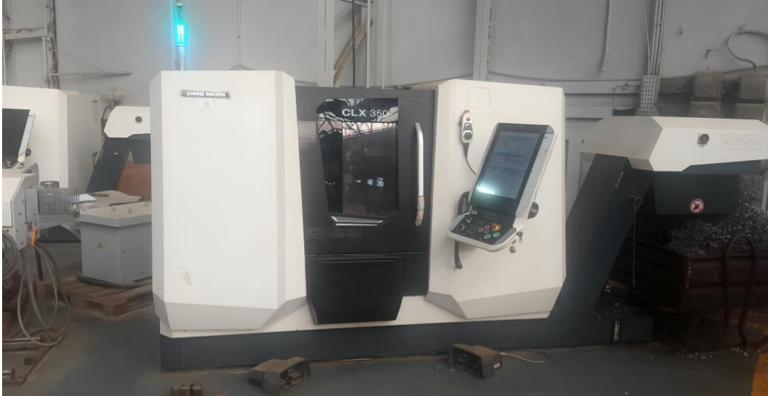
Figure III.1: machine d'essai tour CNC DMG MORI (CLX350).
