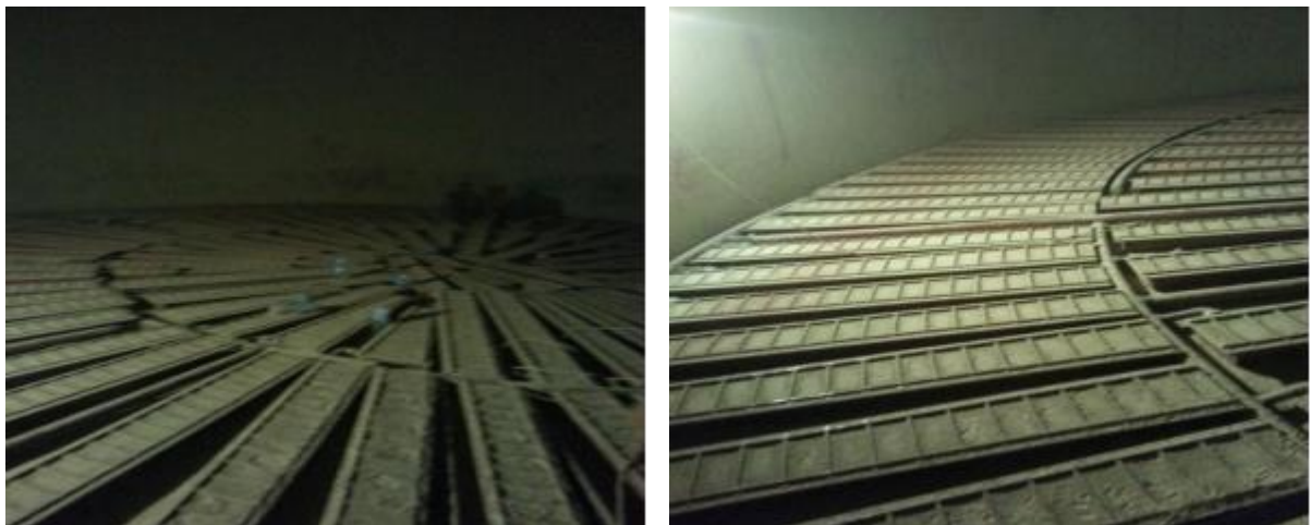
Figure I.8 : Photos représentatives d'un silo de l'intérieur et la répartition des aéroglisteurs au sein de ce dernier.
