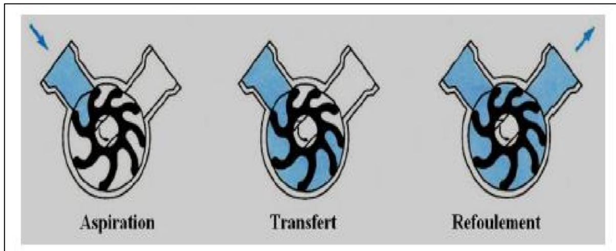
Figure II.13: Pompe à palettes flexibles
