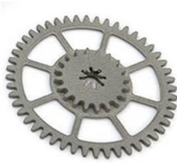
Figure II.15: Impression 3D Aluminium avec la technologie SLM
