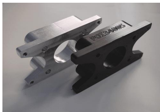
Figure 16: Support de roulement - Pièce usinée et pièce imprimée en 3D puis gravée
