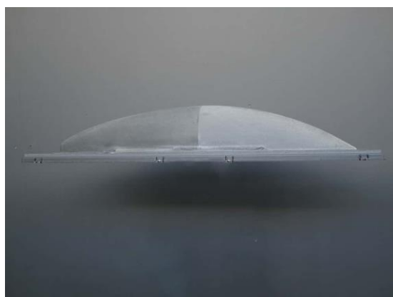
Figure 19: Moule imprimé en 3D et usiné
