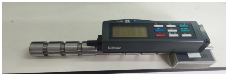
Figure III.6 : rugosimètre TR220 (2D)
