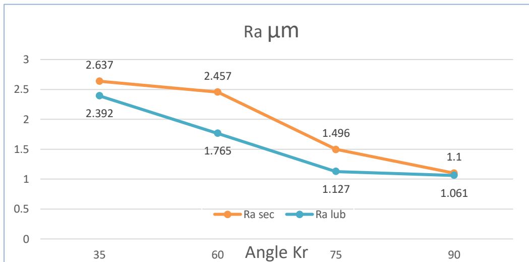
Figure III.24: Comparaison entre les résultats obtenues de Ra avec et sans lubrification pour l'essai 1.1 et 1.2
