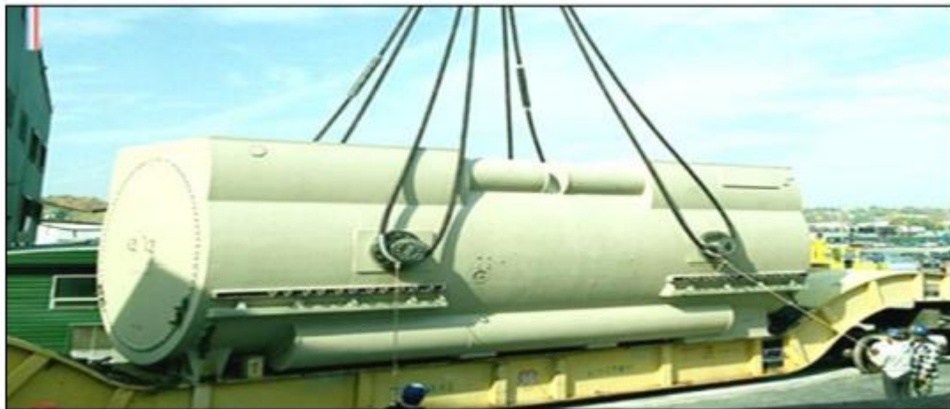
Fig I.12. A smooth pole alternator.
