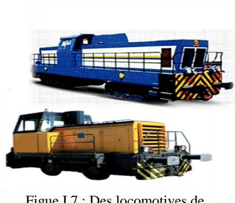
Figure I.7 : Des locomotives de manœuvre BB800H diesel, hydraulique [1].
