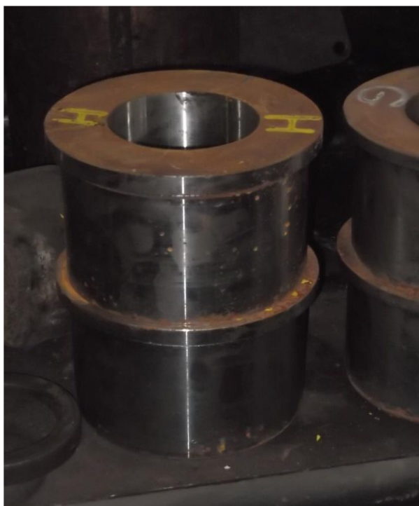
Figure III.8 : Photo de la douille de l'accouplement
