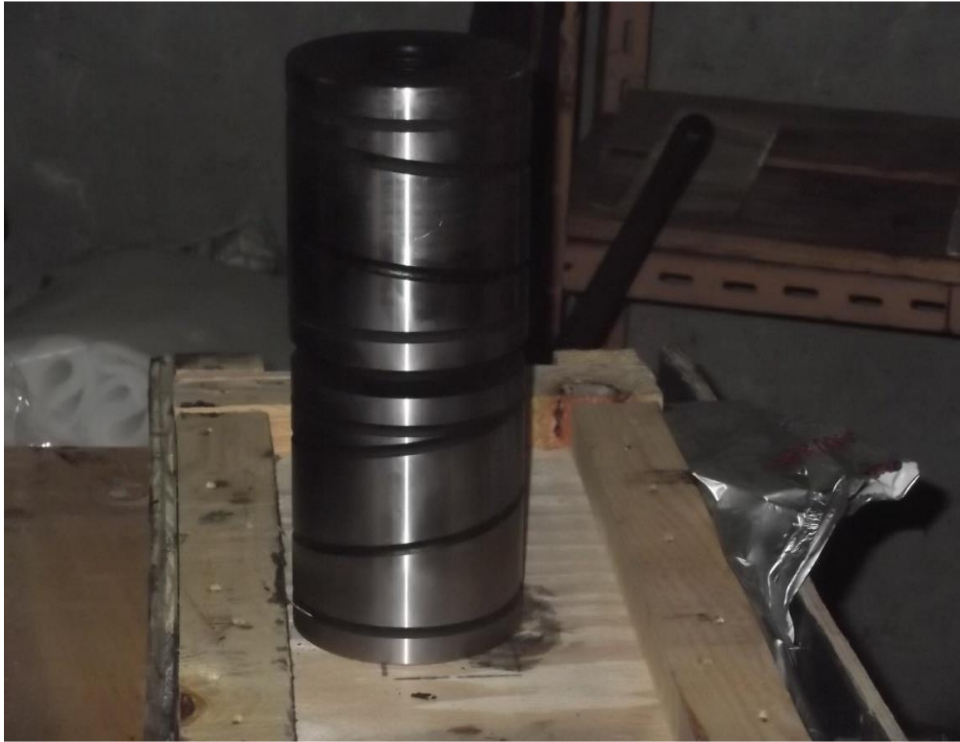
Figure III.10: Photo de la goupille de l'accouplement HOLSET.
