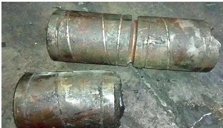
Figure III.12: Photo d'une goupille rompue.
