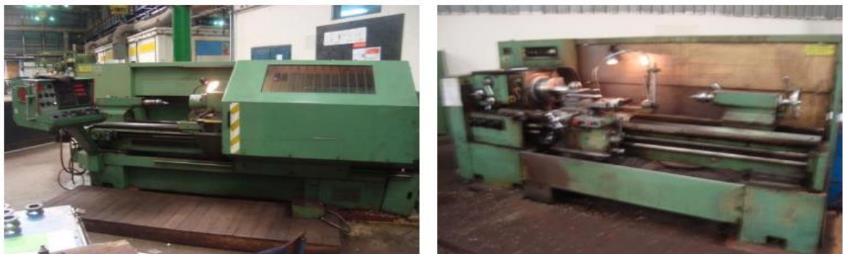
Fig. I.6. a).Tournage parallèle (//) conventionnel à CNC, b). Tour Parallèle 16D20.
