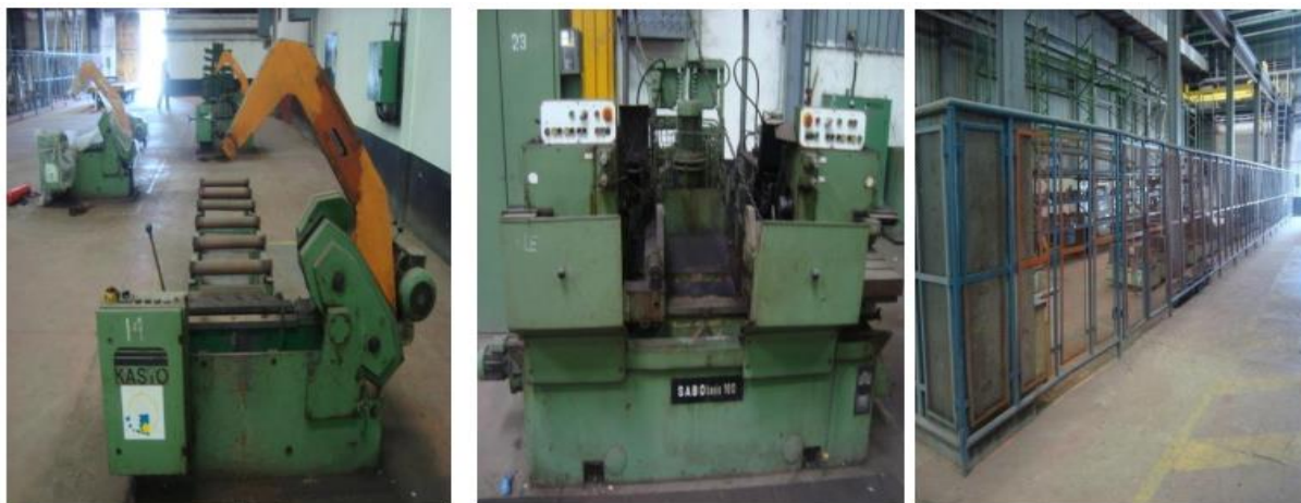
Fig. I.8. a). Scie alternatif EBS 360 U, b). Machine à centré SABO, c). Stock des pièces fini.
