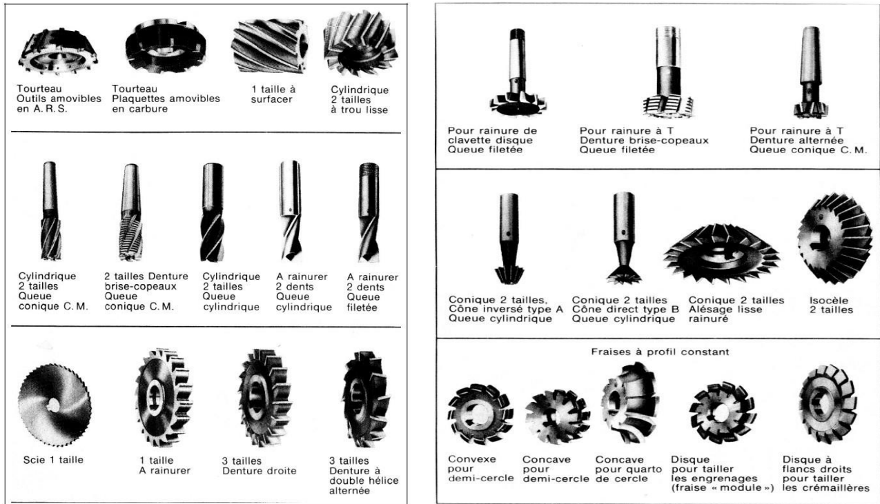
Figure III.2 : Les différents types de fraises
