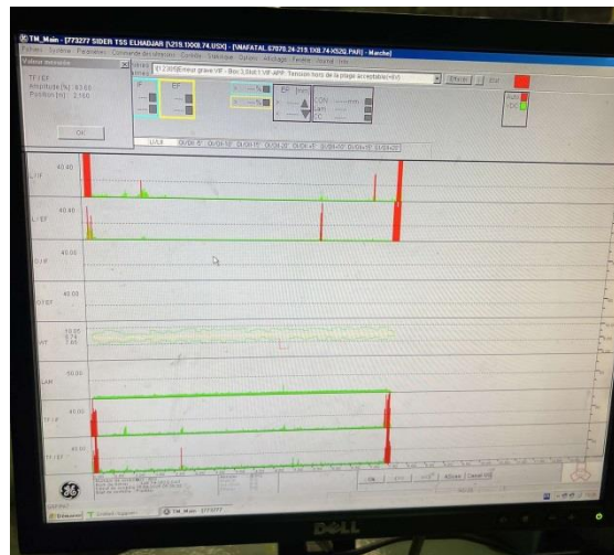
Figure 13. Les pics rouges sur l'écran du logiciel qui présente les défauts
