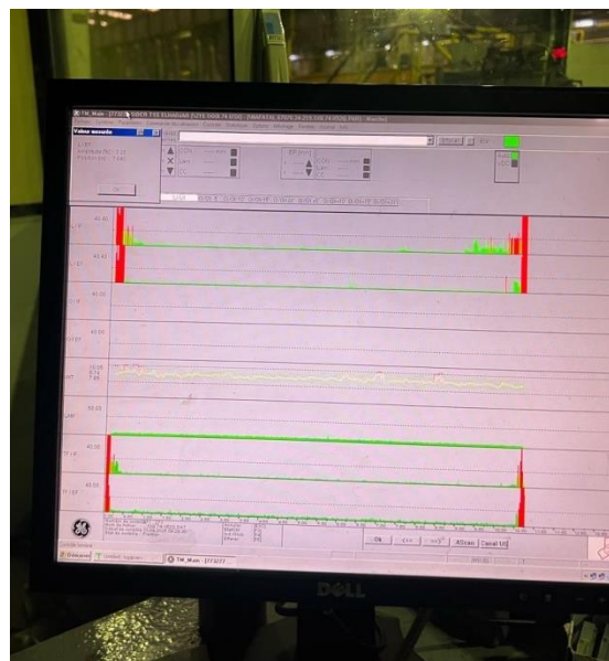
Figure 17. Aucun pic rouge (aucun défaut détecté)
