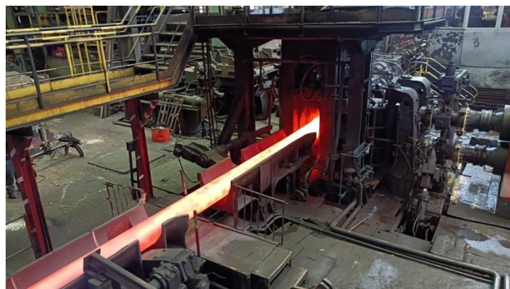
Figure 10. Un tube sans soudure entrain de fabrication
