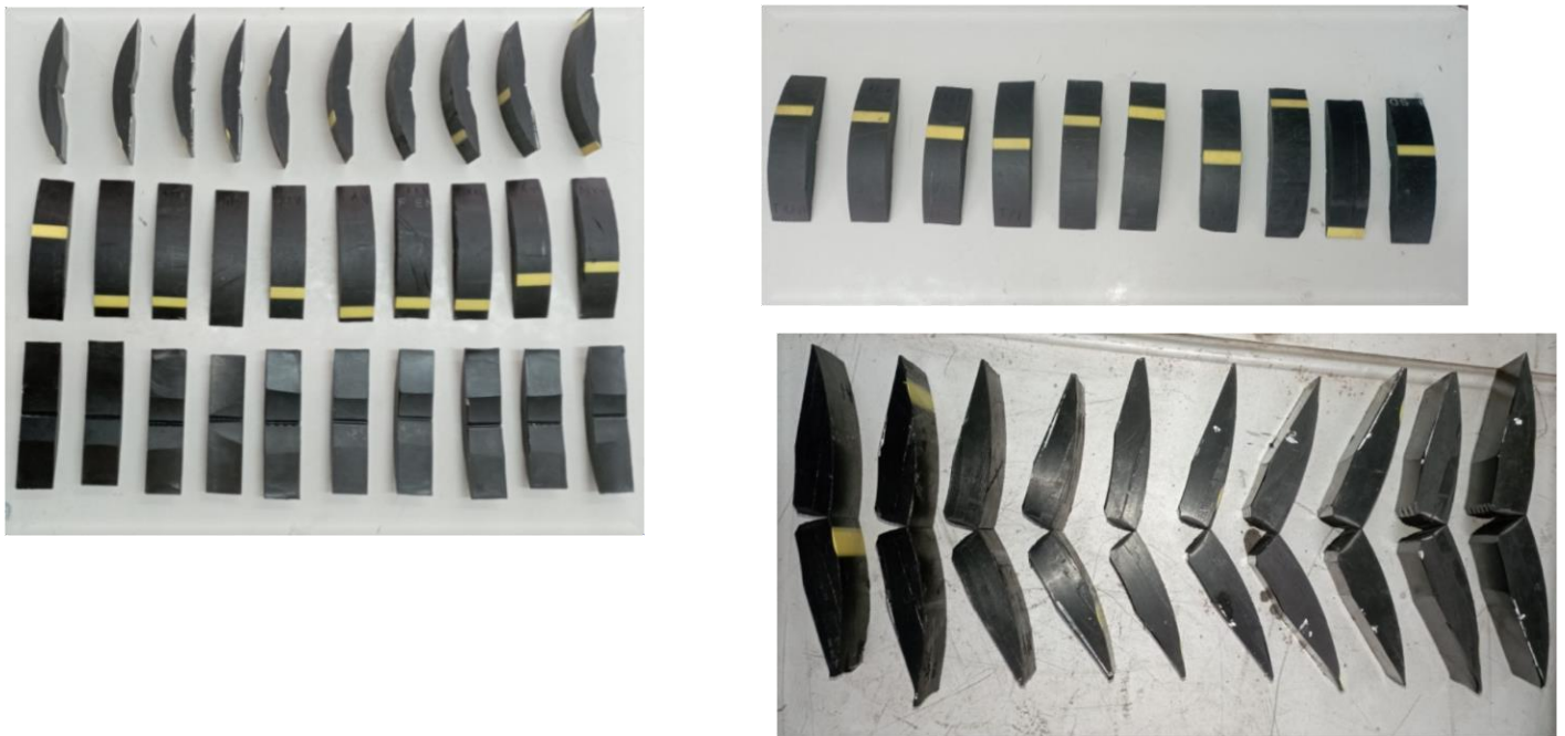
Figure II.35 : Vues de la machine d'essai et des éprouvettes testées
