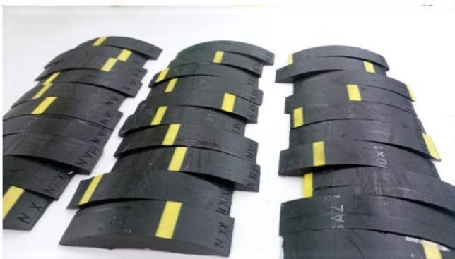
Figure II. 25: Codification des groupes d'éprouvettes en arcs groupes d'éprouvettes en arcs des parallélépipédiques
