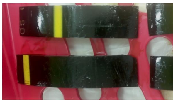
Figure II. 29: Photo montre les éprouvettes NST immergées dans les trois milieux (pétrole brut, Essence, Gas-oil) et (As received)
