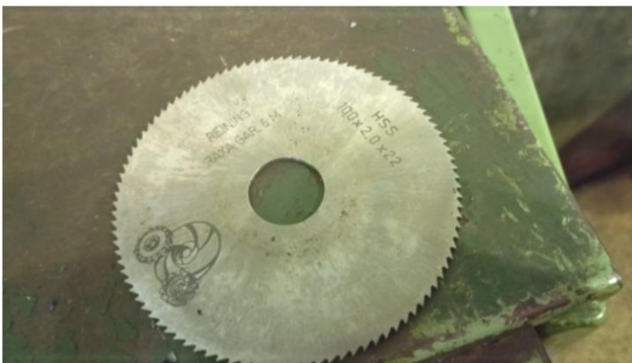
Figure II. 20: Outil de l'entaillage d'arcs
