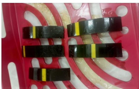
Figure II.30: Eprouvettes arc juste après immersion
