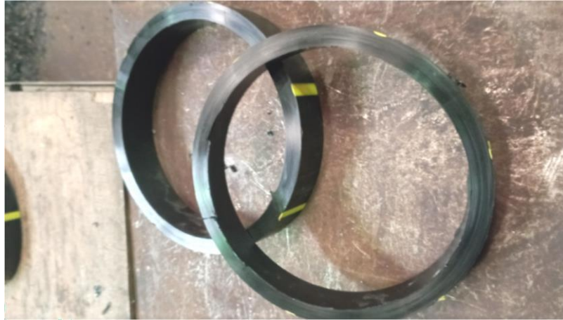
Figure II .14 : Anneaux pour les éprouvettes parallélépipédiques (section rectangulaire)
