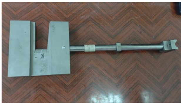
Figure II.34 : Le pendule utilisé dans notre l'essai de choc (25 Joules)
