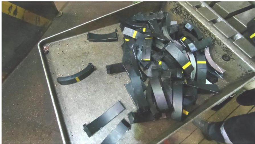
Figure II .16: Eprouvettes en arc avant l'entaillage
