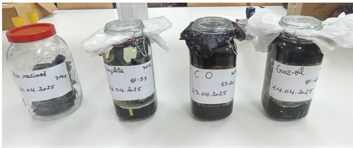
Figure II. 29: Photo montre les éprouvettes NST immergées dans les trois milieux (pétrole brut, Essence, Gas-oil) et (As received)
