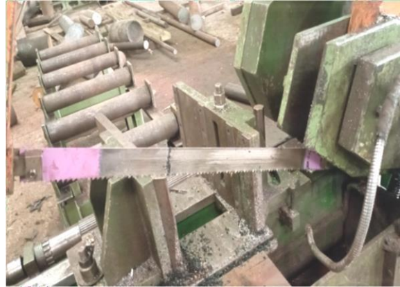
Figure II.4: Scie à métaux (coupe du tube HDPE)
