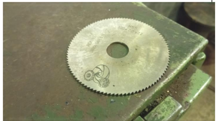
Figure II. 20: Outil de l'entaillage d'arcs
