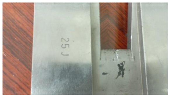
Figure II.34 : Le pendule utilisé dans notre l'essai de choc (25 Joules)
