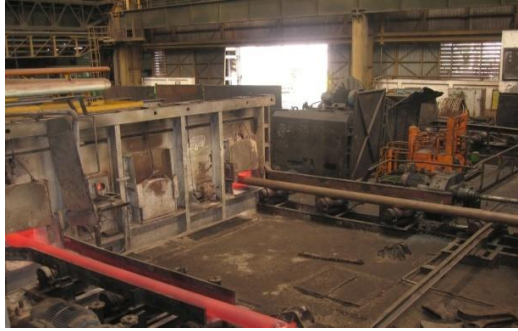
Figure I.8 : Four à longerons.
