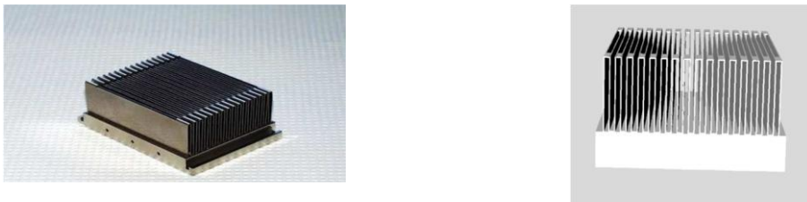
Figure 2.13. (a) Dissipateur thermique typique basé sur Al pour Intel P4_Standard (b) Domaine de calcul pour P4_Special [24].
