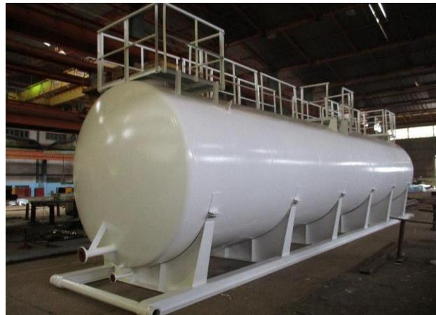
Cuve 100 m<sup>3</sup> pour stockage de carburant
