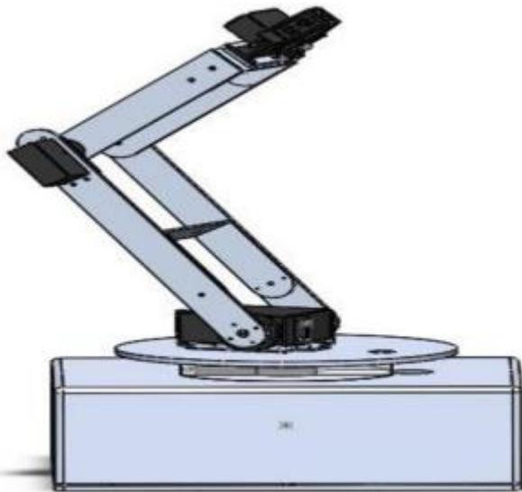
**Figure 2.5 :** un robot manipulateur de 3 degré de liberté (3ddl)
