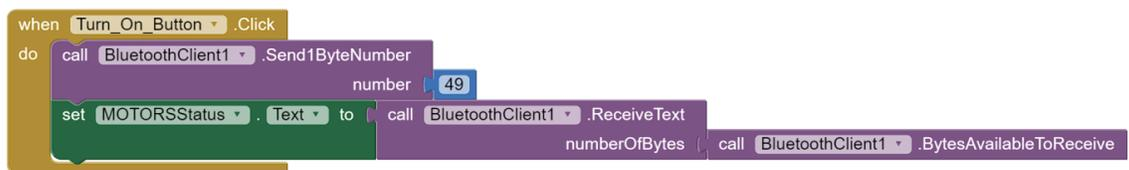
Figure 3. 13. Groupe de blocs de bouton TURN : ON
