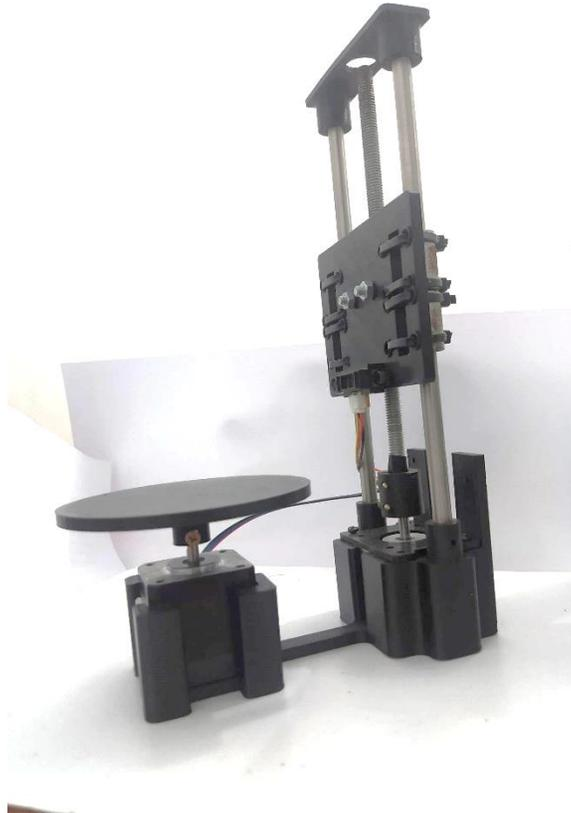
Figure 2. 24 . Photo réelle du scanner d'objet 3D réalisé
