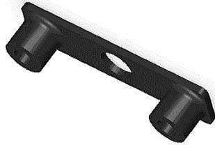
Figure 2. 22. Modèle 3D de la plaque de fixation
