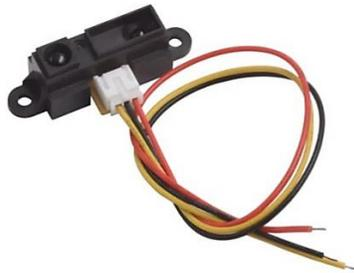
Figure 2. 5. Le capteur Sharp GP2Y0A41SK0F
