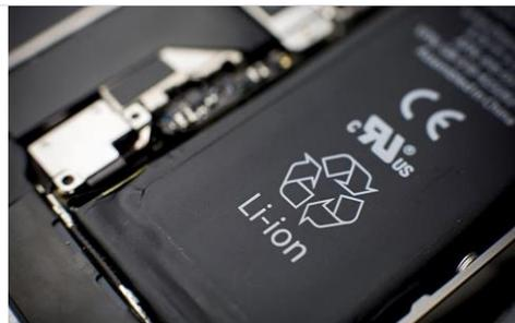
**Figure 8: batterie d'ordinateur portable**
