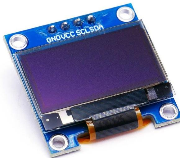
**Figure II.8 :** L’oled (SSD1306)
