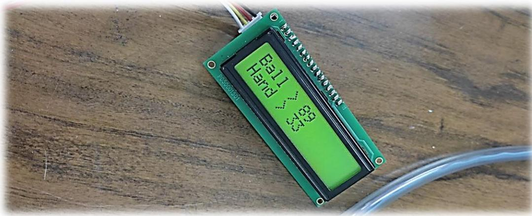
Figure 21 Afficheur LCD
