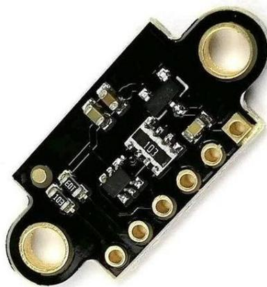
Figure 14 LE CAPTEUR DE DISTANCE VL53L0X
