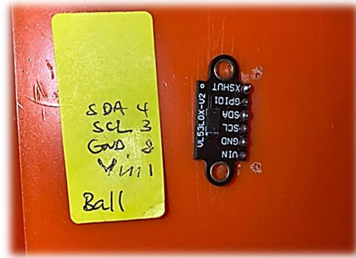
Figure 17 Capteur laser VL53L0x V2 pour la position de balle
